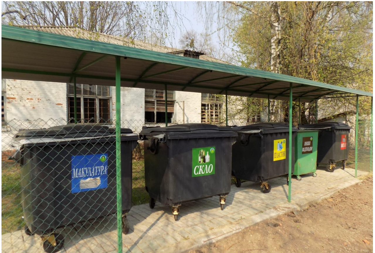
Рисунок 2.2.2. Приклад контейнерного майданчика, що облаштований для роздільного збирання ТПВ
