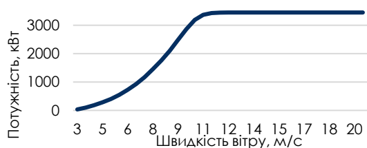
Рис. 1.11. Крива потужності вітротурбіни Vestas V126-3.45.
